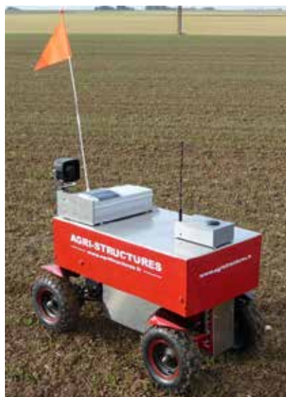
Drone terrestre Agri-Structures couplé à un effaroucheur Agri-Protect (source Agri-Structures)
